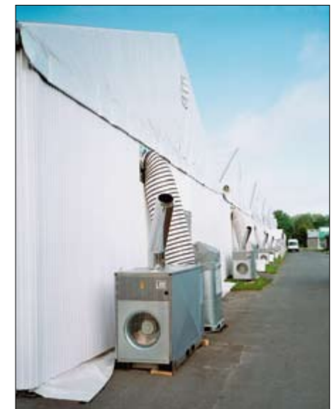
Warme Luft wird über einen Schlauch bis zu 100 m im Zelt optimal verteilt
